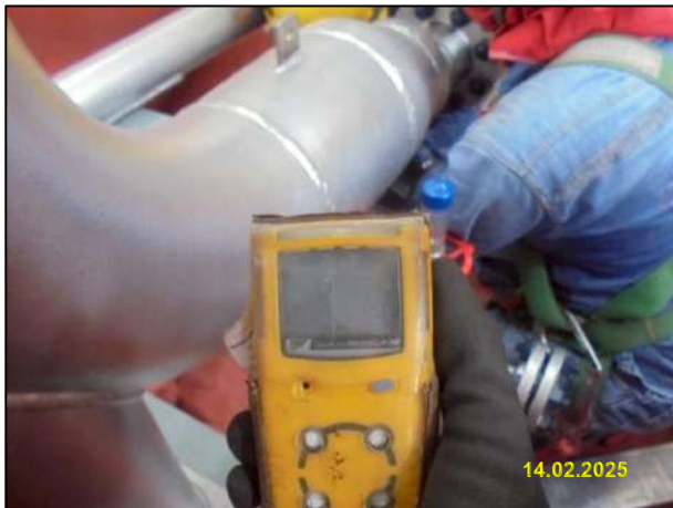
การตรวจวัดประเมินสภาพอากาศในพื้นที่อับอากาศ
