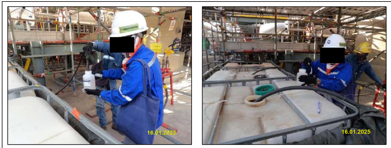
รูปที่ 2-26 การติดตามตรวจสอบคุณภาพน้ำจากกิจกรรมทดสอบการรับแรงดันของท่อและอุปกรณ์ต่างๆ ด้วยแรงดันน้ำ (Hydrostatic Test)
