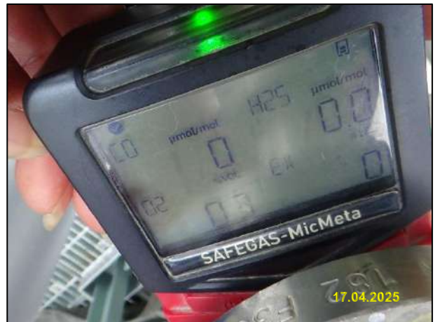
การตรวจวัดประเมินสภาพอากาศในพื้นที่อับอากาศ
