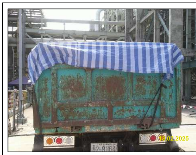
รูปที่ 2-4 รถบรรทุกขนส่งวัสดุก่อสร้างมีผ้าไปปิดคลุมอย่างมิดชิด
